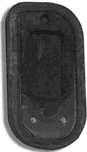
DEFEKT / STARK UNDICHT
